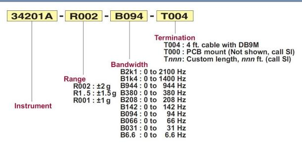
34201A Accelerometer 电话:+86 755 2641 9890 传真:+86 755 2641 9680 www.bill-well.com 深圳市亿为测控电子有限公司
